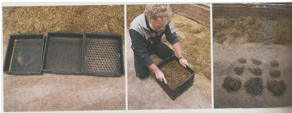
Obrázek 10: Zkouška separace krmiva, Hulsen (2011)
