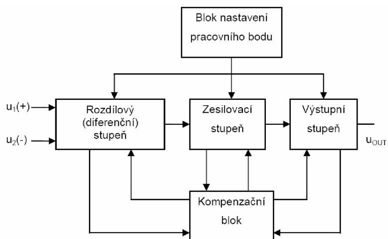
Obr. 3 - Blokové schéma operačního zesilovače
