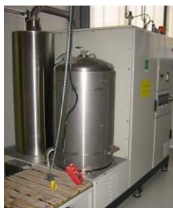
Obr. 8 Destilační zařízení na zpracování rtuti
