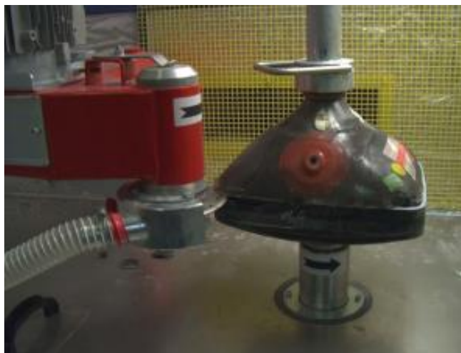
Obr. 5 Rozřezávání CRT obrazovky
