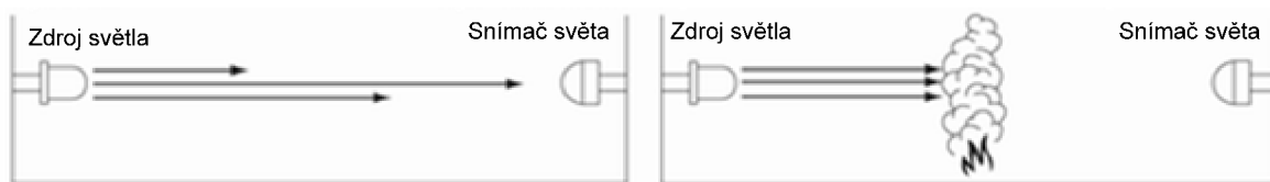
Obr. 7: Princip optického hlásiče kouře – přerušení paprsku světla
