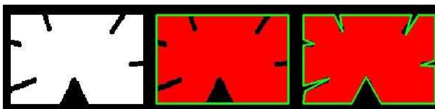
Obr. 19: Aproximace kontur v OpenCV [17]
