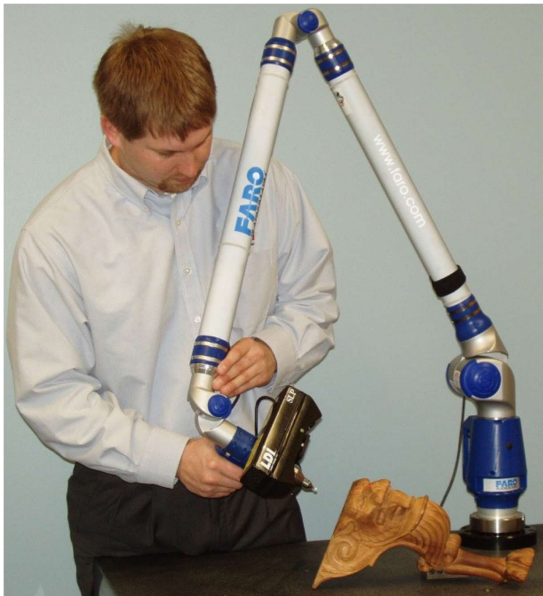
Obr. 1: Mechanická paže FaroArm [3]
