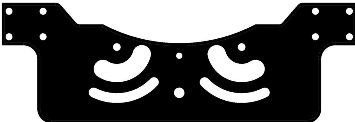
Obr. 24 Pohyblivá příruba zepředu.
