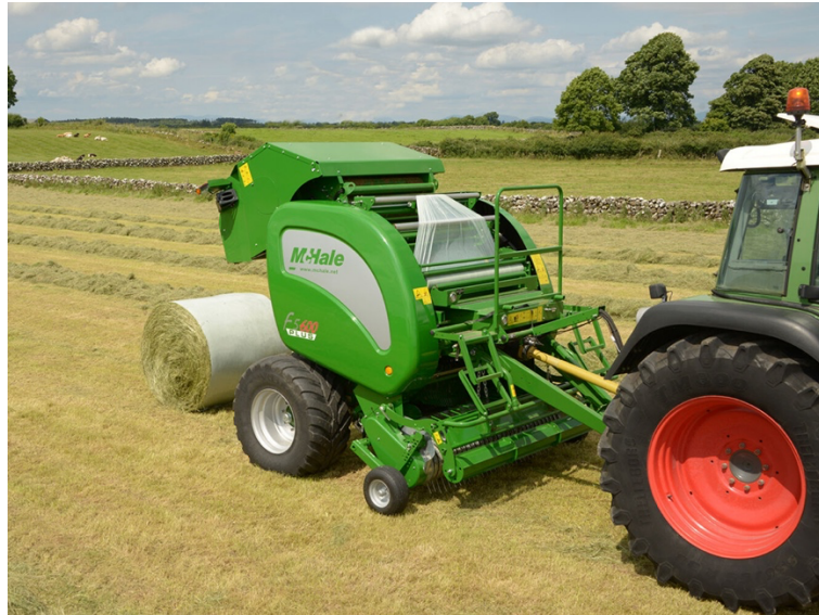
Obrázek 2-13 Vázání do fólie (McHale, 2024)
