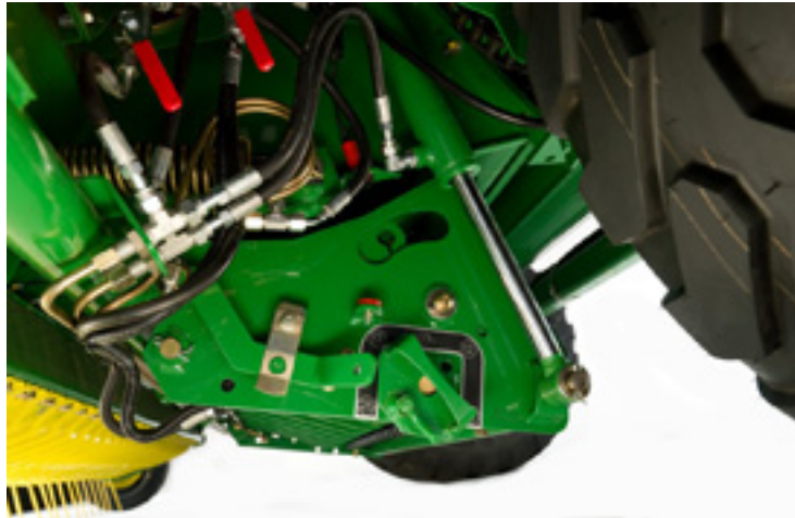
Obrázek 2-18 Padací dno John Deere (Deere, 2024)
