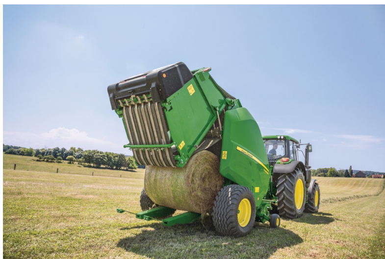
Obrázek 2-5 lis s variabilní komorou (Strom, 2024)
