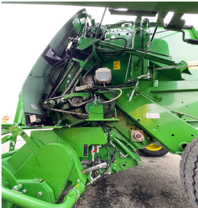
Obrázek 2-19 pohon válců (Landwirt, 2024)
