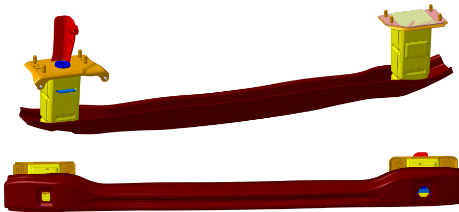
Obr. 2.1: Příklad výrobku - nárazník pro osobní automobil
