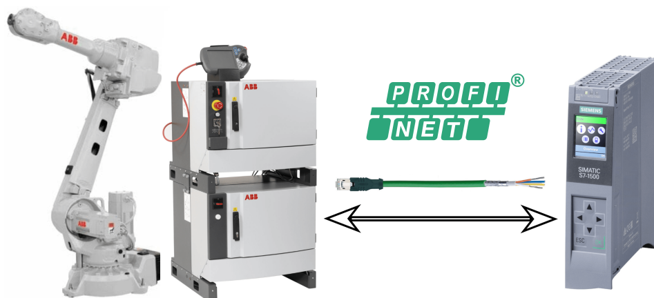
Obr. 1.6: Komunikace ABB robot a Siemens PLC [2][6][7][8]
