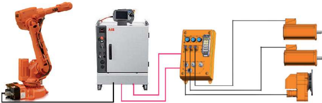
Obr. 3.11: Schéma propojení robota, smb boxu a externích motorů
