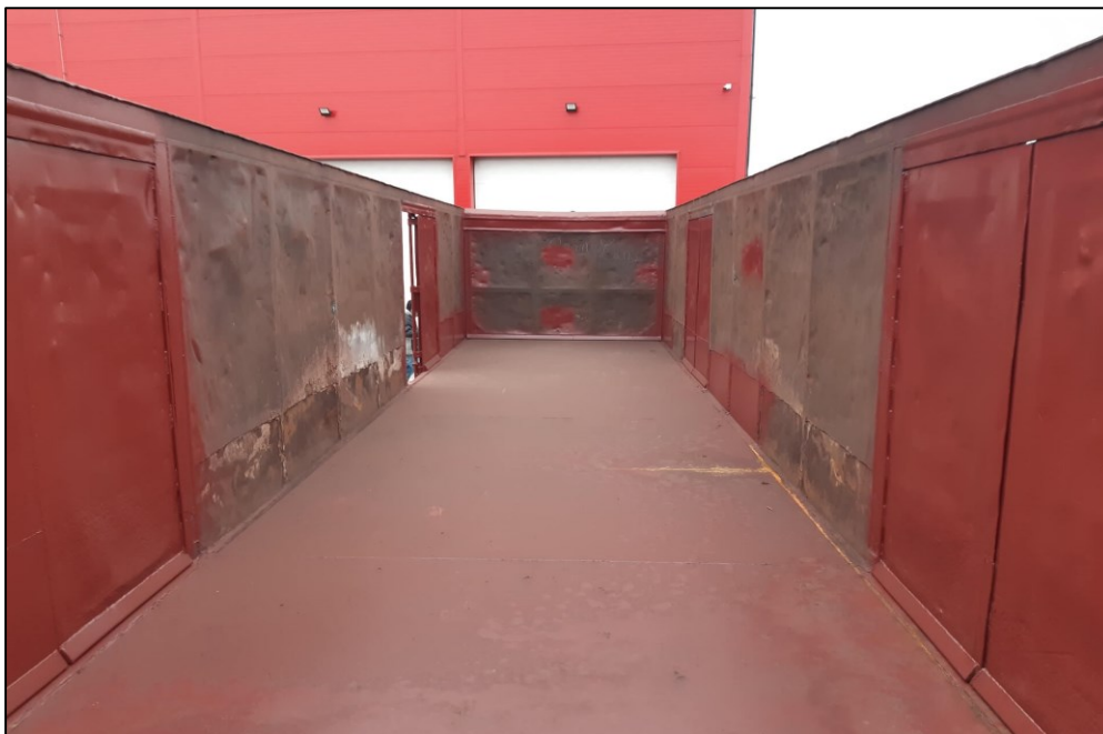
Obr. 3.3 Vozeň Eas – pohľad z vnútra Zdroj: https://www.zscargo.sk/
