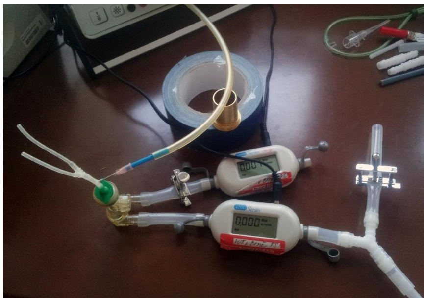
Obrázek 12 Měřící prvky zapojené ve ventilačním okruhu v laboratoři
