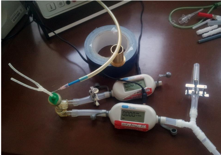
Obrázek 12 Měřicí prvky zapojené ve ventilačním okruhu v laboratoři
