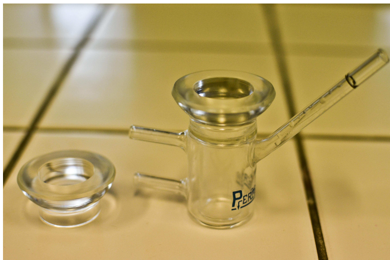
Obr. 5.1: Donorová a akceptorová část difúzní cely
