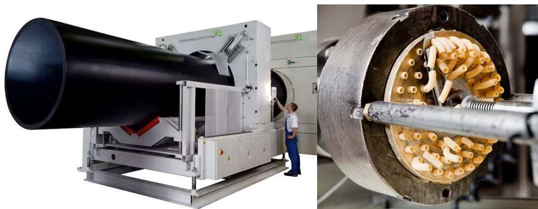
Obr. 20 Použití extruze pro výrobu trubky [47] a těstovin [48]
