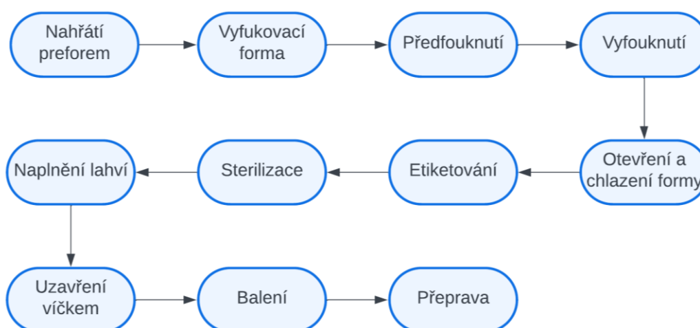
Obr. 27 Blokové schéma procesu vyfukování PET lahve a následného zpracování
