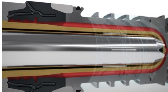
Obr. 25 Detail dutiny na výrobu preformy [53]
