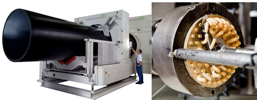
Obr. 20 Použití extruze pro výrobu trubky [47] a těstovin [48]
