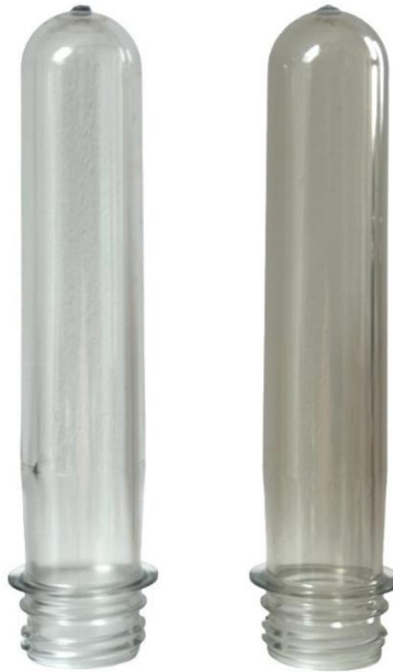
Obr. 23 Preforma z vPET a 50 % rPET
