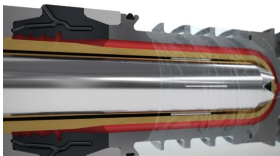
Obr. 25 Detail dutiny na výrobu preformy [53]
