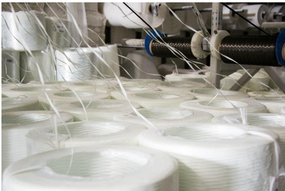
Obr. 19 Zásobník výztuží, společnosti Prefa Kompozity a. s. [21].
