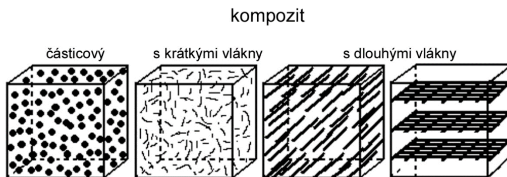
Obr. 3 Dělení kompozitních materiálů podle tvaru a uspořádání výztuže [5].
