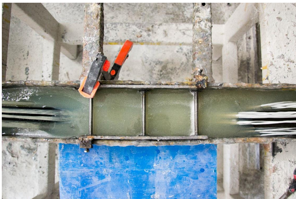
Obr. 22 Smáčení vláken v polymerní lázni, společnost Prefa Kompozity a. s. [21].
