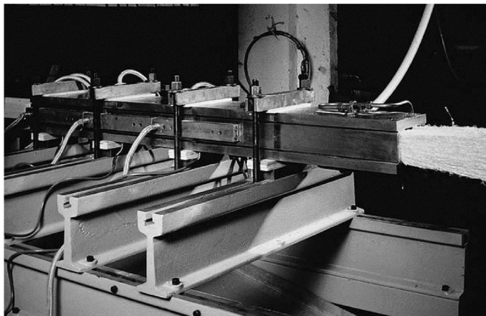
Obr. 24 Názorná ukázka vytvrzovací hlavy [22].
