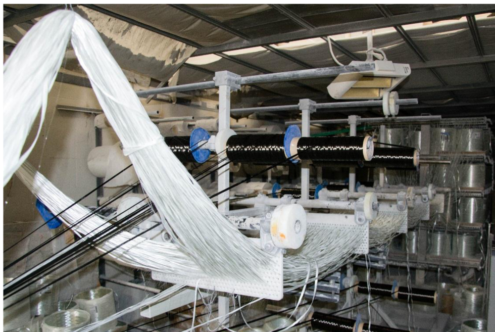
Obr. 18 Zásobník výztuží, společnosti Prefa Kompozity, a. s. [21].
