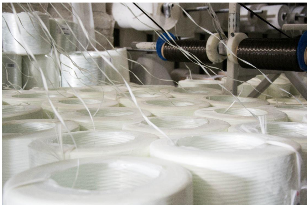
Obr. 19 Zásobník výztuží, společnosti Prefa Kompozity a. s. [21].
