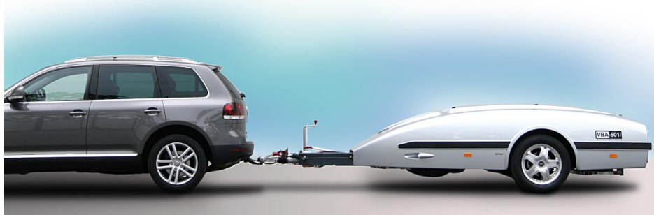
Obr. 1: Mobilní dynamometr s tažným vozidlem [1]
