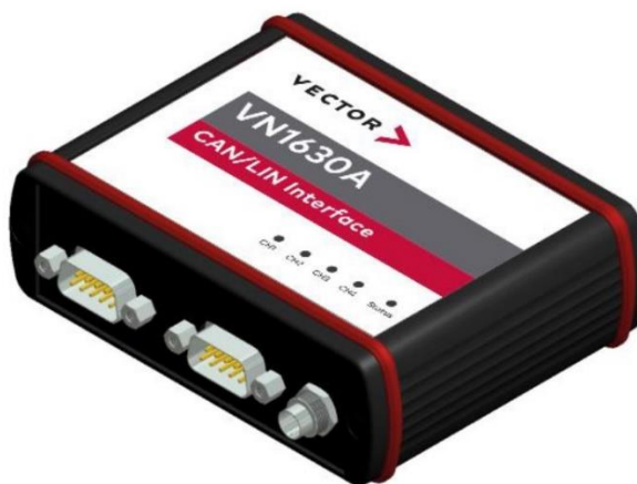
Obr. 21: Zařízení Vector VN1630A (upraveno z [18])
