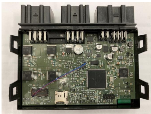
Obr. 18: Fyzická podoba hlavní ŘJ (Main ECU)
