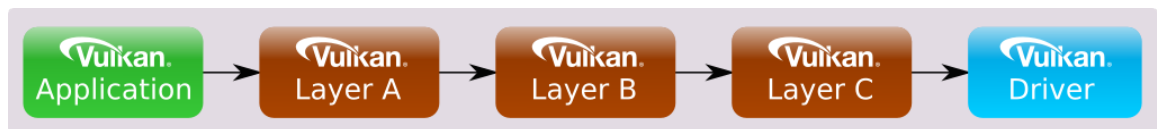
Obr. 2.4: Optimalizovaný reťazec volaní úrovne Device. Prevzaté z [18].
