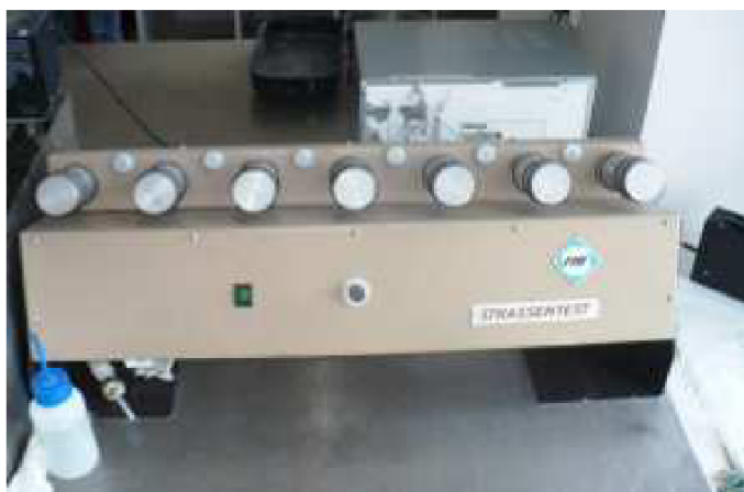
Obrázek 9 Zařízení pro rotaci pyknometrů se vzorkem a trichloretylenem kolem šikmé osy
