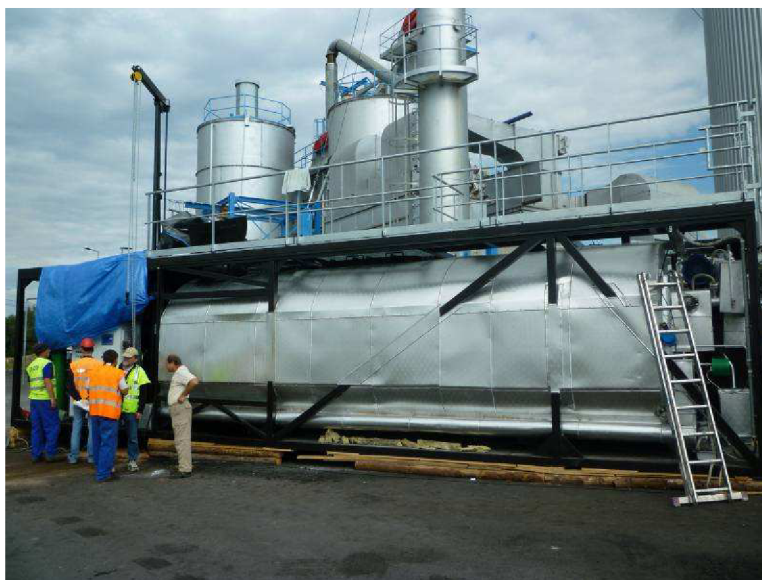
Obrázek 1 Mísící zařízení G Asfalt (blender)
