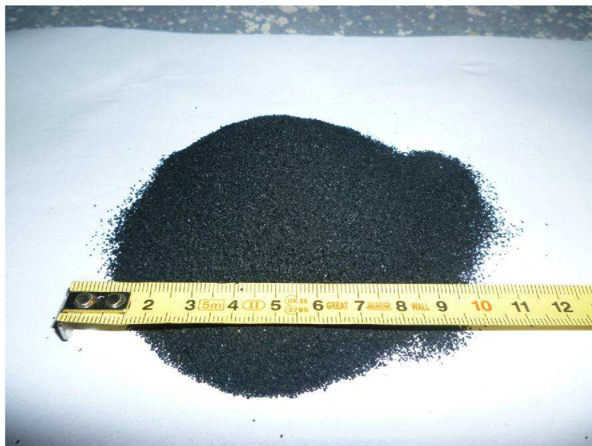
Obrázek 32 Zrnitost pryžového granulátu Kovosteel
