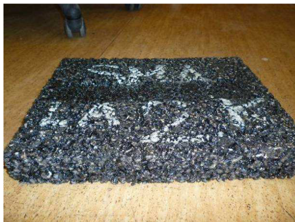
Obrázek 36 Deska ze směsi SMA 8 LA KS po zkoušce poježdění kolem
