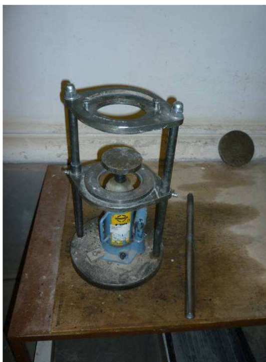
Obrázek 17 Zařízení pro vytlačení zkušebních těles z formy
