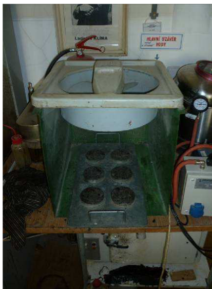
Obrázek 16 Ventilátor pro ochlazení čerstvě zhuštěných těles se šesti kruhovými podstavci
