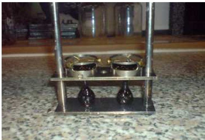
Obrázek 6 Sestava po měření bodu měknutí
