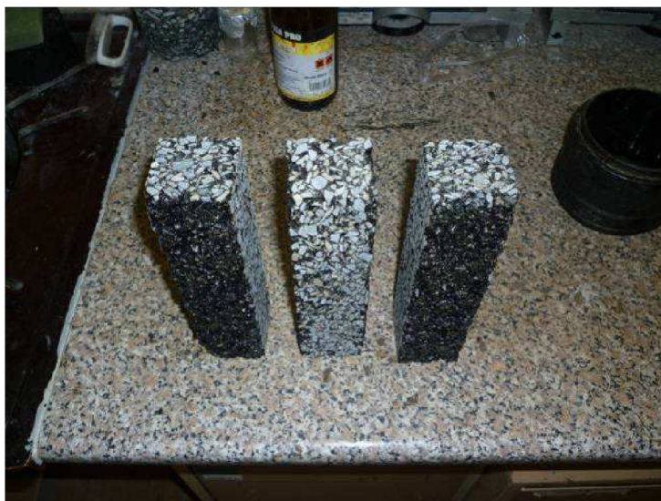
Obrázek 29 Nařezané zkušební tělesa ve tvaru trámečku
