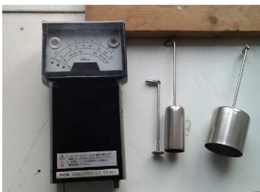
Obrázek 7 Viskozimetr s různými nástavci
