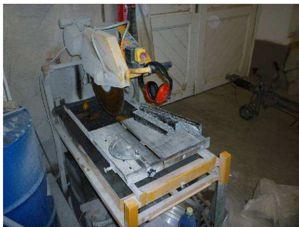
Obrázek 24 Kotoučová pila s diamantovým kotoučem
