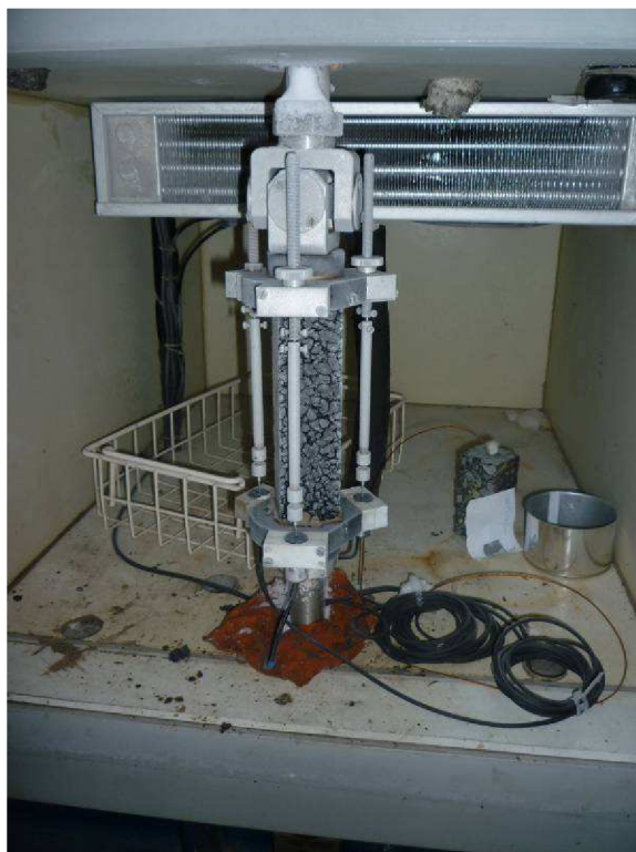
Obrázek 31 Zkušební těleso upnuté ve zkušebním zařízení po ukončení zkoušky
