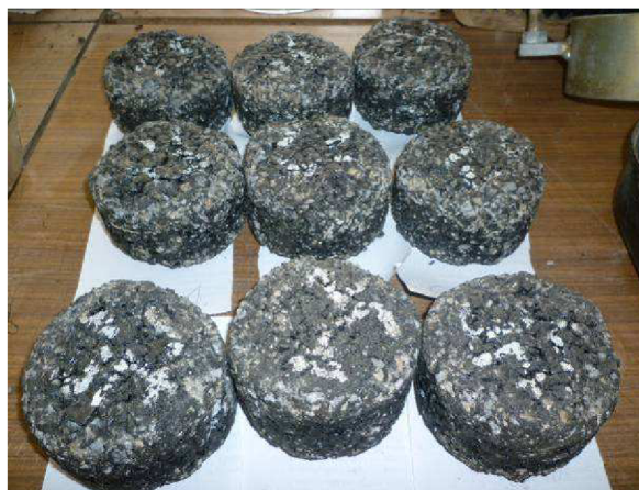
Obrázek 12 Válcová zkušební tělesa po zkoušce ztráty částic
