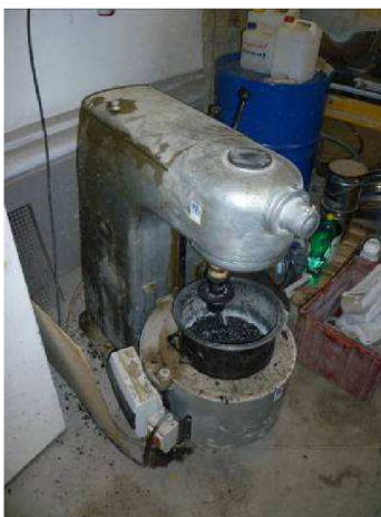
Obrázek 23 Míchací zařízení pro obalení kameniva pojivem
