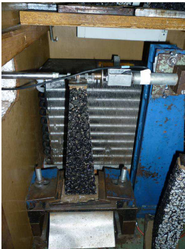
Obrázek 28 Upevněné zkušební těleso ze směsi SMA 8 LA KS pro měření únavových charakteristik
