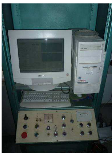
Obrázek 27 Ovládací jednotka pro měření modulu tuhosti a únavových charakteristik
