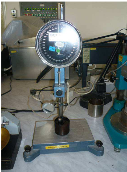
Obrázek 2 Penetrometr se zkušebním tělesem pro určení resilience
