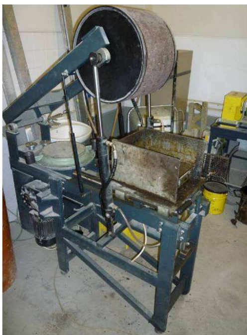
Obrázek 20 Lamelový zhutňovač desek
