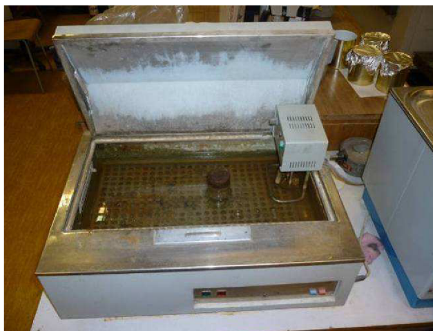
Obrázek 18 Vodní lázeň pro temperaci mokrých těles
