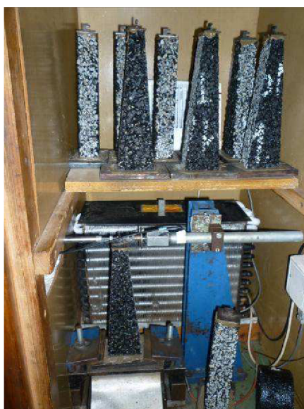
Obrázek 26 Temperování zkušebních těles a zkušební těleso upevněné ve zkušebním zařízení pro měření modulu tuhosti
