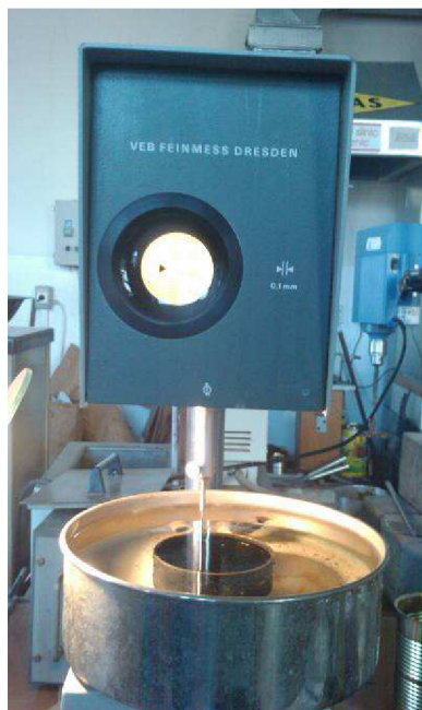
Obrázek 3 Penetrometr se zkušebním tělesem pro určení penetrace
