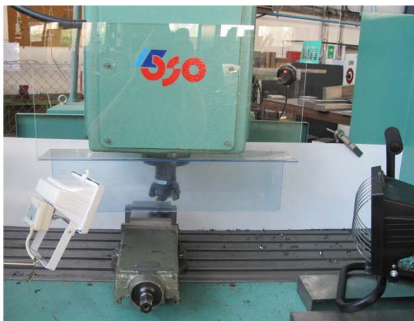
Obr. 4.22 Pohled na kryt, upevněný na vřeteník
