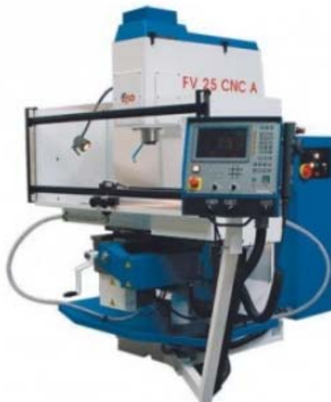
Obr. 4.12 Univerzální frézka FV 25 CNC A [41]
