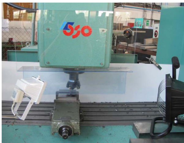
Obr. 4.22 Pohled na kryt, upevněný na vřeteník
