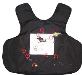
Obr. 1.4 Test neprůstřelné vesty [37]
