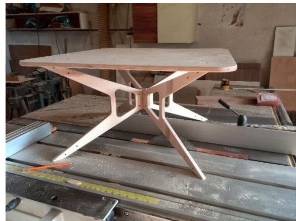
Obr. 73. Zkušební sestavení stolku
