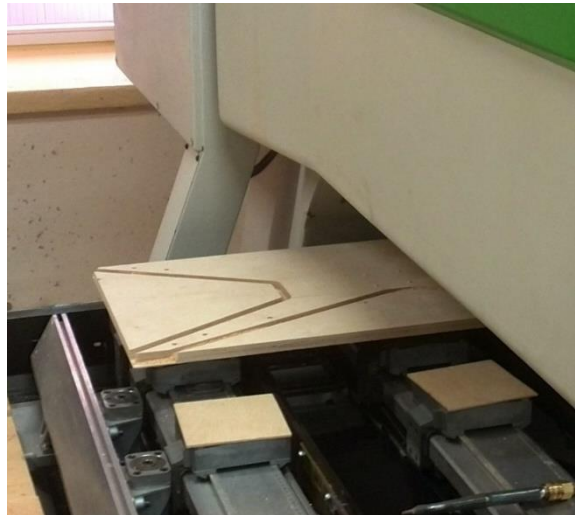
Obr. 69. Opracování podstavy na CNC obráběcím centru
