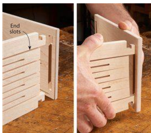
Obr. 43. Spojení napružením částí dílce
