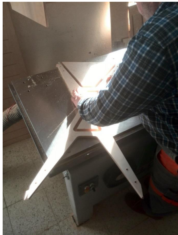
Obr. 70. Ofrézování a kulacení polotovaru
