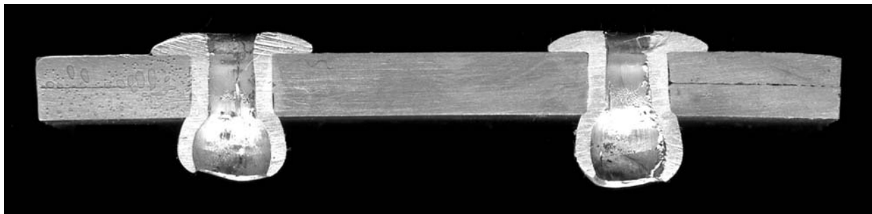
Obr.26 Řez trnovými nýty po zanýtování [A2]
