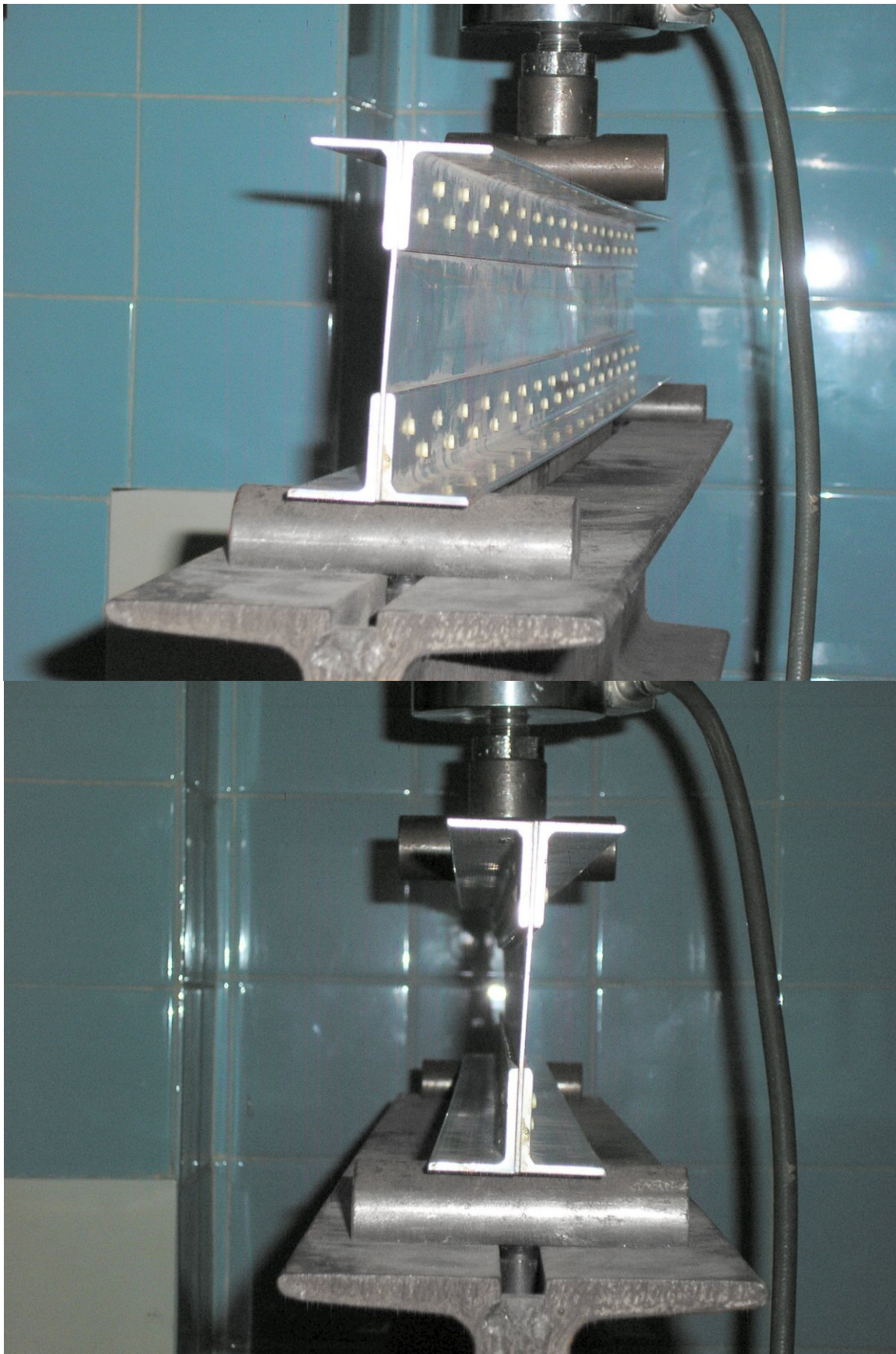
Obr.116 Vybočení stojiny při zátěžovém cyklu dosahujícím 8000 N
