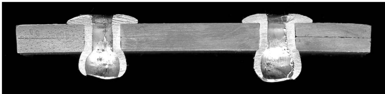
Obr.26 Řez trnovými nýty po zanýtování [A2]
