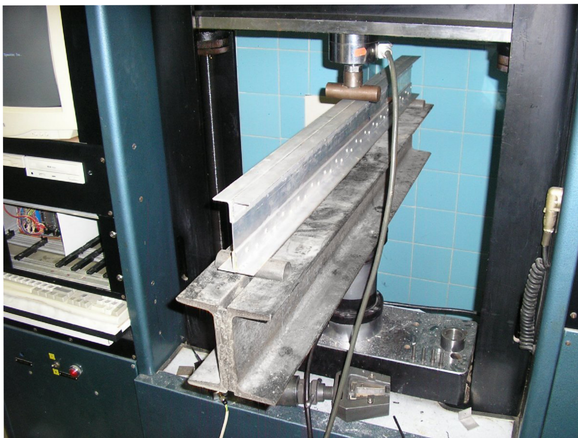
Obr.113 Uspořádání měřícího aparátu při zjišťování tuhosti nosníku
