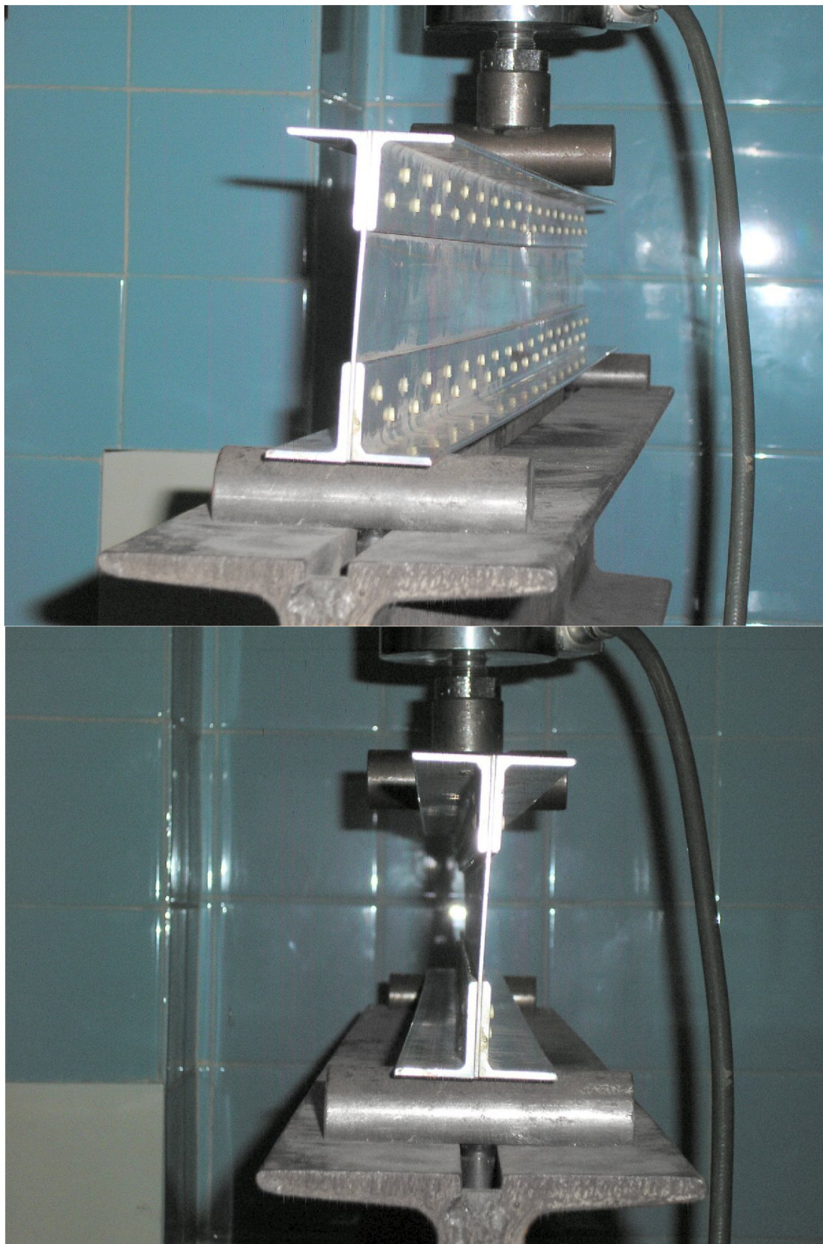
Obr.116 Vybočení stojiny při zátěžovém cyklu dosahujícím 8000 N
