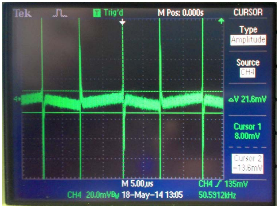
Obr. 7.8 Zvlnenie výstupného napätia zdroja pri plnej záťaži
