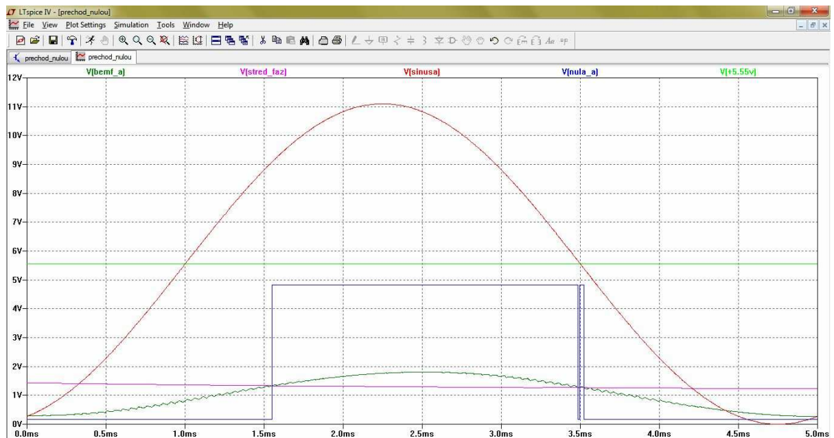
Obr. 4.17 Preklopenie komparátoru v okamihu prechodu nulou
