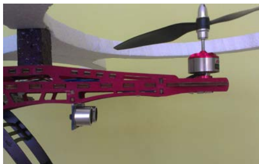
Obr. 5.12 Umiestnenie ultrazvukového senzoru na ramene quadkoptera
