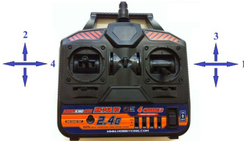
Obr. 3.2 Pripojenie kanálov k páčkovým ovládačom vysielča
