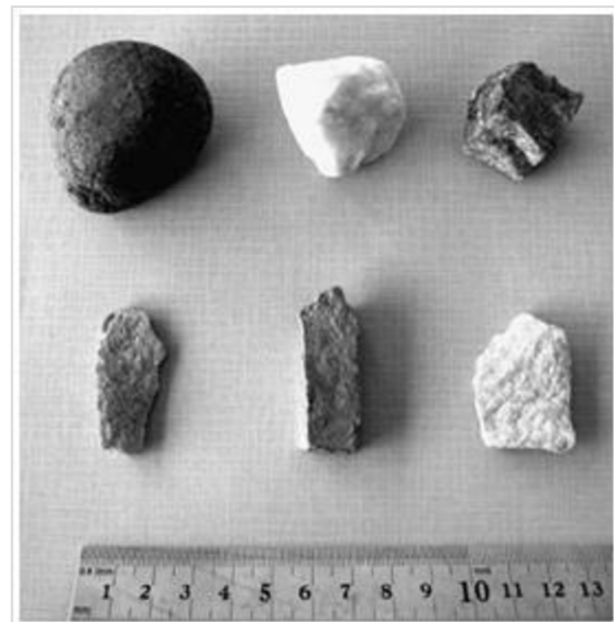
Obrázek 9: Tvary (podle BS 812: 1989) jsou ve směru hodinových ručiček zleva shora: Zaoblené, nepravidelné, úhlové, vložkané, protáhlé, vložkané + protáhlé.
