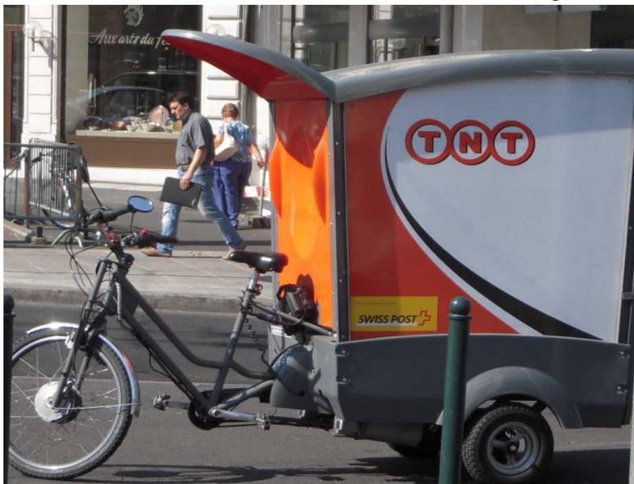
Obrázek 37 – Elektrické kolo s vozíkem a možností solárního pohonu
