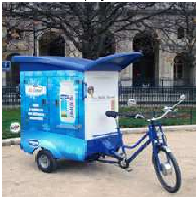
Obrázek 38 – Elektrokolo určené pro distribuci mléčných produktů
