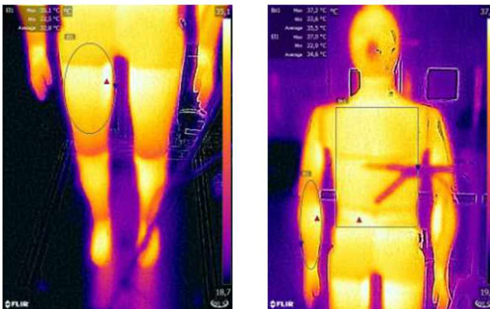
Obrázek 31: Snímek z termokamery Flir one – zobrazení nahřátého povrchu manekýna pro oblasti stehna, hrudníku a předloktí pro startovací teplotu 5°C.
