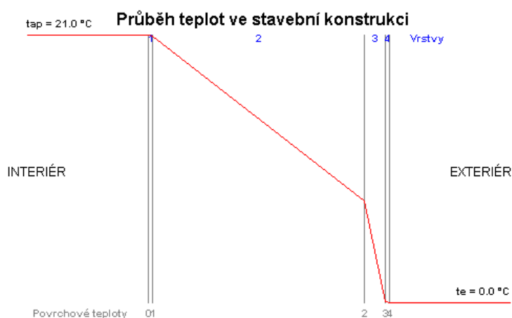
Obr. 6.1: Prostup tepla stěnou
