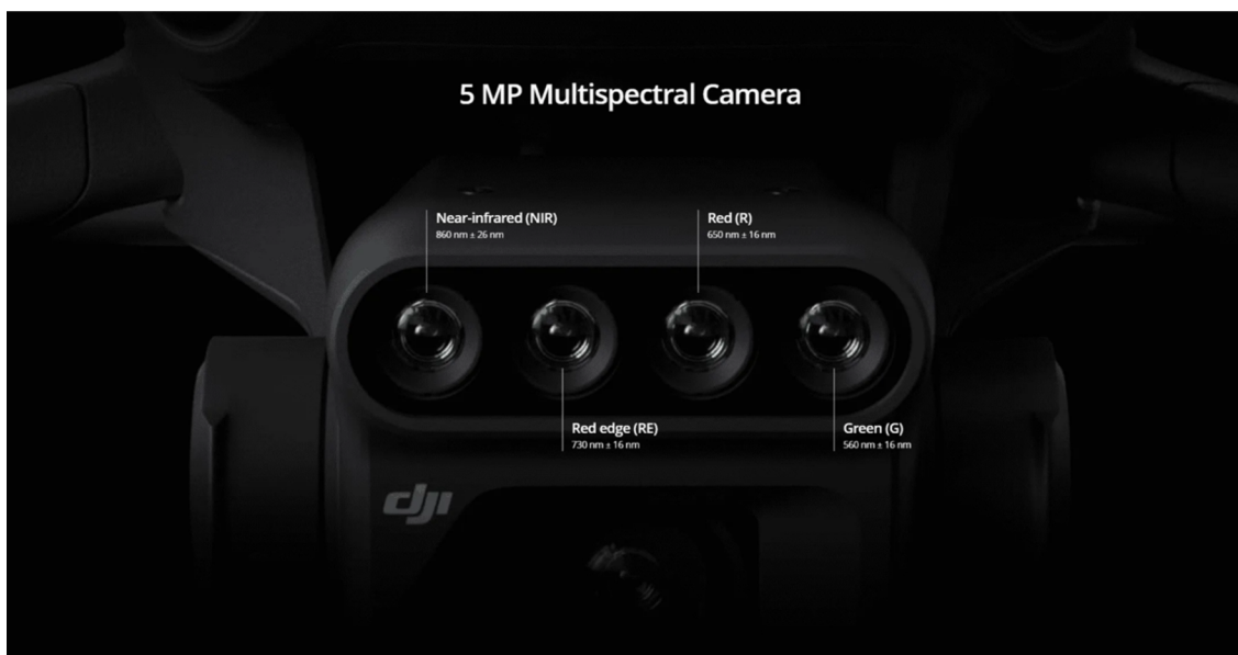
Obrázek 4 Multispektrální kamera dronu DJI Mavic 3M[21]
