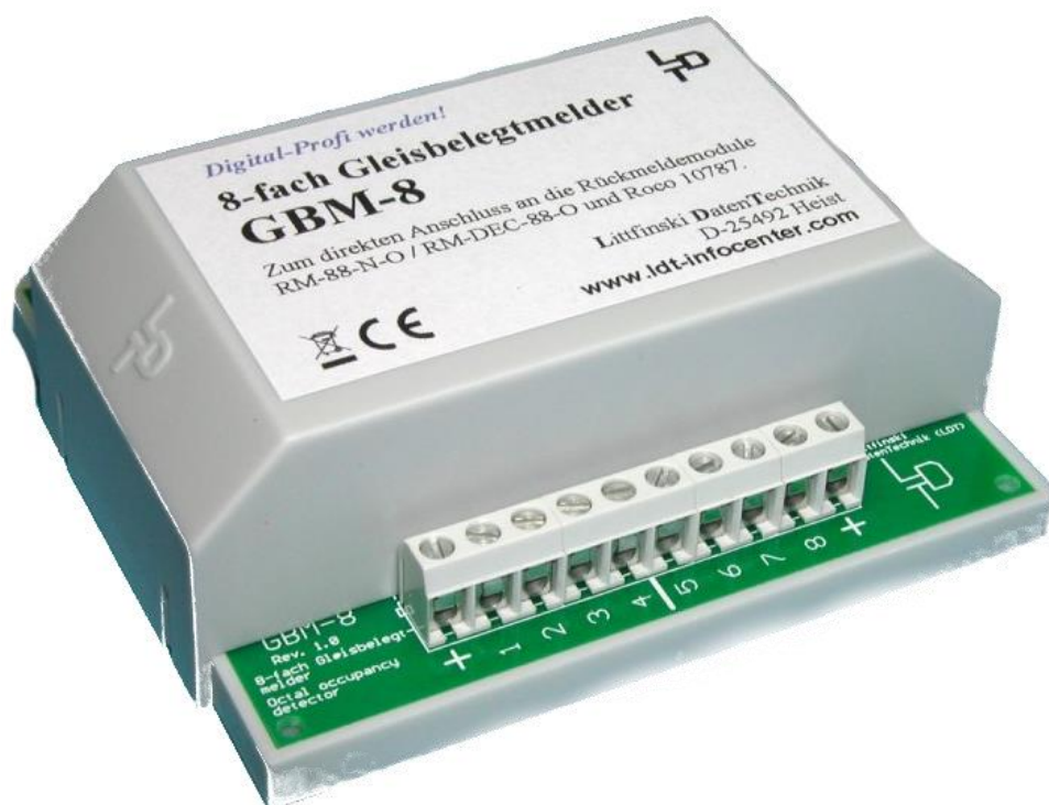
Obrázek 6 - napěťový snímač obsazení GBM-8-G
