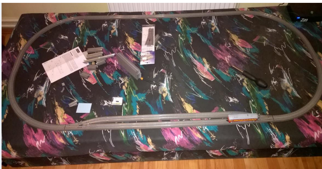
Obrázek 13 - obyčejná válenda v počátcích posloužila nejen k testování základních funkcí ústředny a lokomotiv, ale především jako vizuální předloha plochy finálního kolejiště - ta je totiž téměř totožná. Naprostá většina odlaďovacích prací při kalibraci lokomotiv byla provedena právě již na tomto „testovacím okruhu“.
