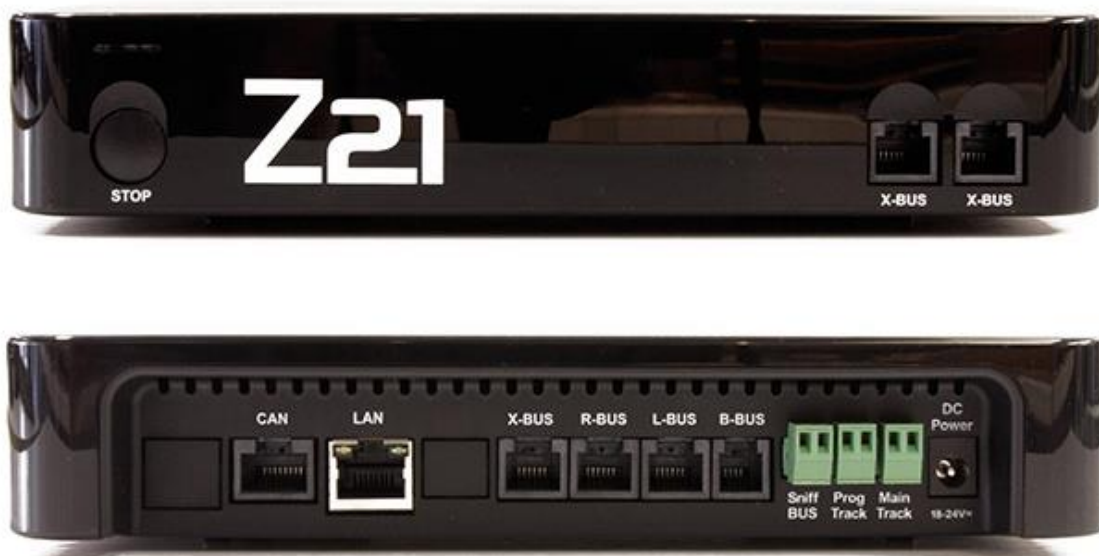
Obrázek 1- náhled na digitální ústřednu Roco Z21 z přední a zadní strany. Na zadní straně jsou vidět konektory veškerých podporovaných sběrnic [19].
