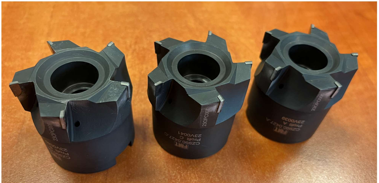
Obr. 26: Experimentální frézy po odjetí druhé série vzorků
