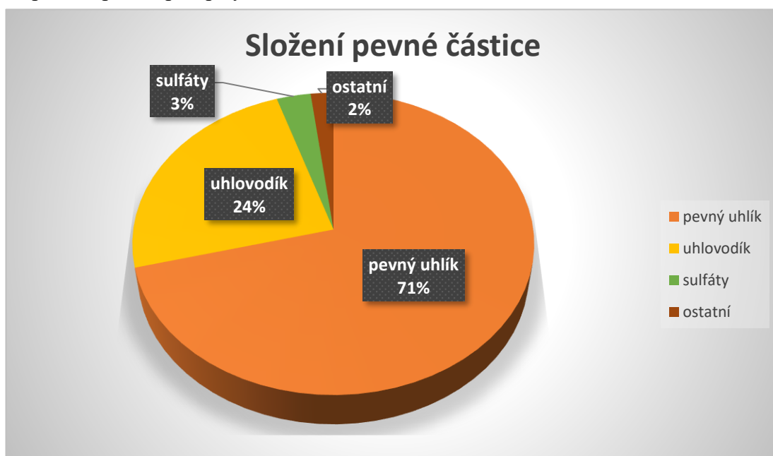
Obrázek 1.1: Grafické znázornění složení pevné částice vznětového motoru (Šmerda, 2013)
