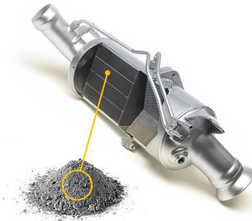
Obrázek 1.6: Odpad sazí z DPF filtru (regeneracedpf.cz, 2022)
