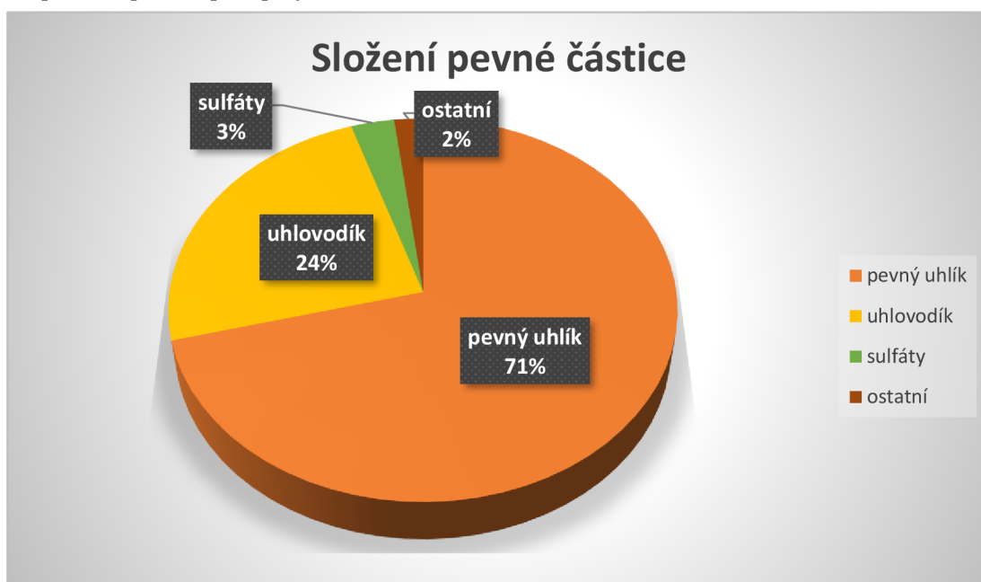
Obrázek 1.1: Grafické znázornění složení pevné částice vznětového motoru (Šmerda, 2013)
