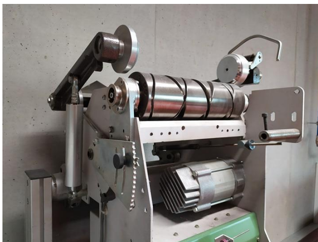
Obr. 6: Přitlačný mechanismus s tlumiči
