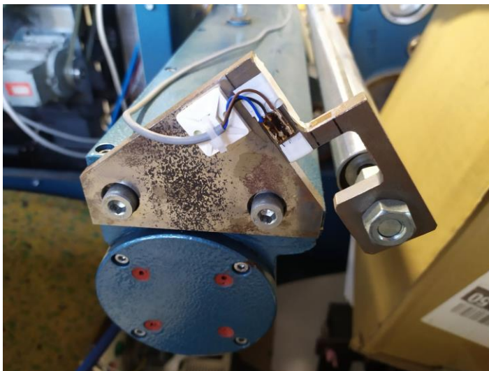
Obr. 12: Tenzometry na uložení přítlačného válce
