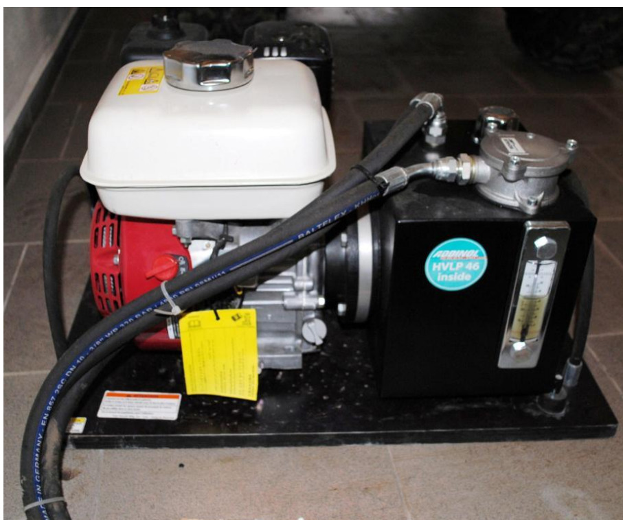
Obrázek č. 6: Agregát a hydraulické čerpadlo
