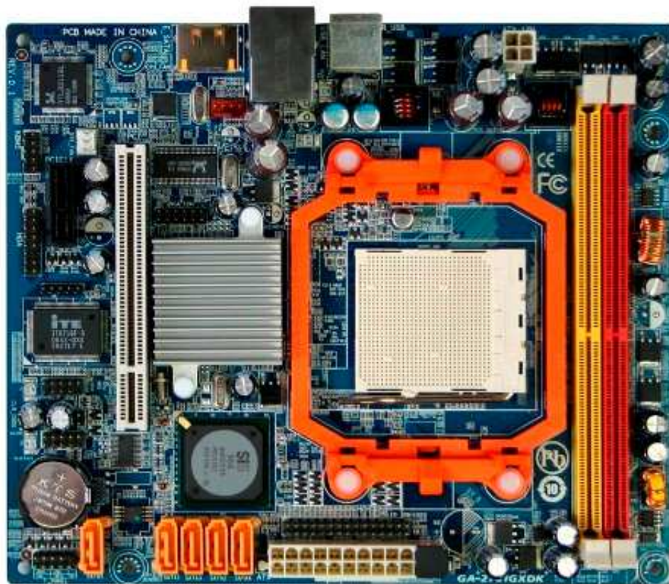
Obrázek 5: První Mini-DTX deska od výrobce Gigabyte [ http://www.gigabyte.com.tw/ ]
