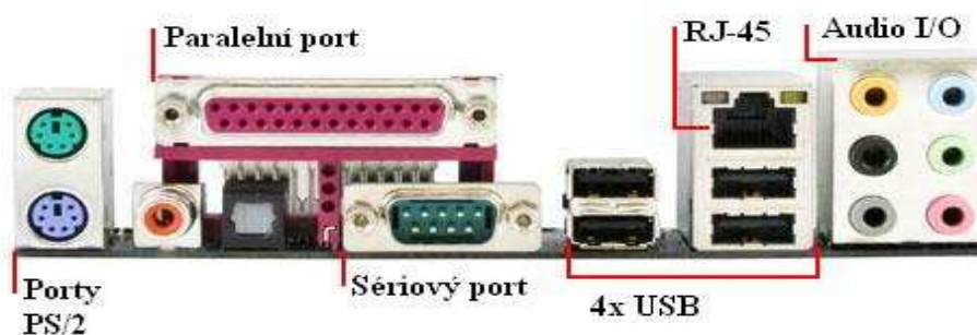
Obrázek 14: Porty vyvedené na zadní straně motherboardu [Autor]
