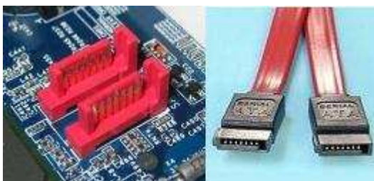
Obrázek 13: Obrázek SATA konektoru a SATA kabelu [Archiv Autora]
