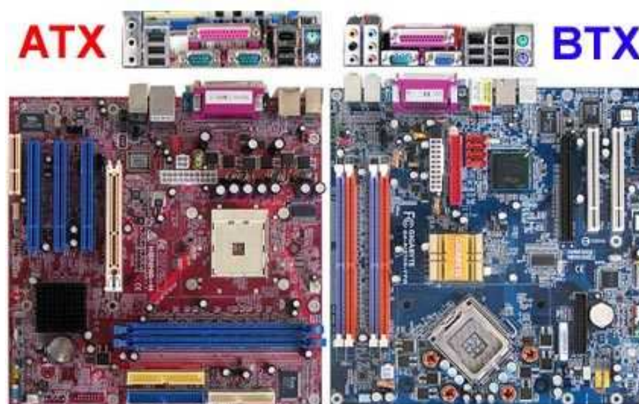
Obrázek 4: Porovnání formátů ATX a BTX [Archiv Autora]
