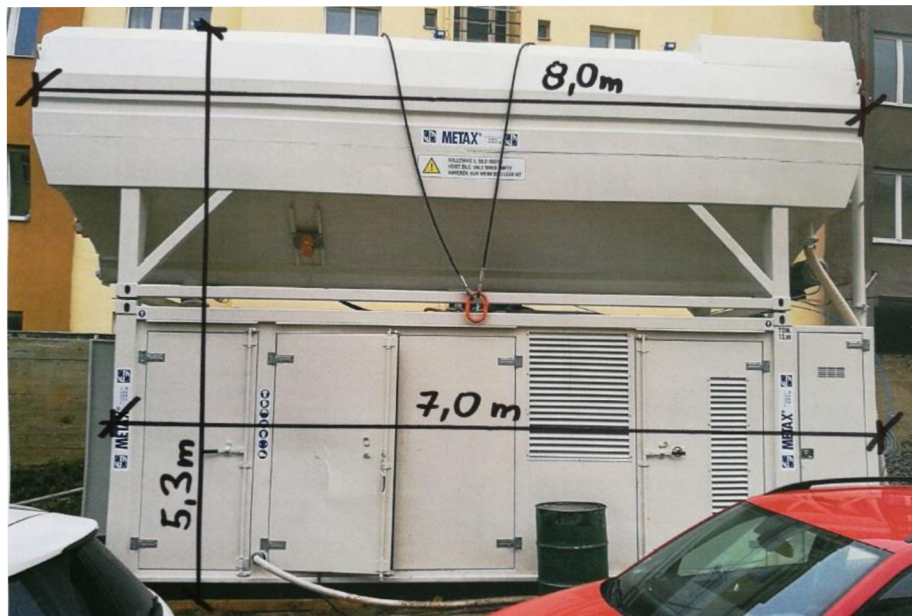
Obrázek 39 Vysokotlaké čerpadlo, míchací zařízení a silo [11]
