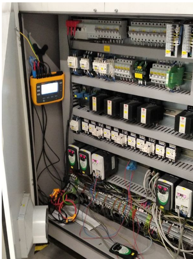
Obr. 3.5: Pripojený záznamník Fluke 1738 na spájkovaciu vlnu
