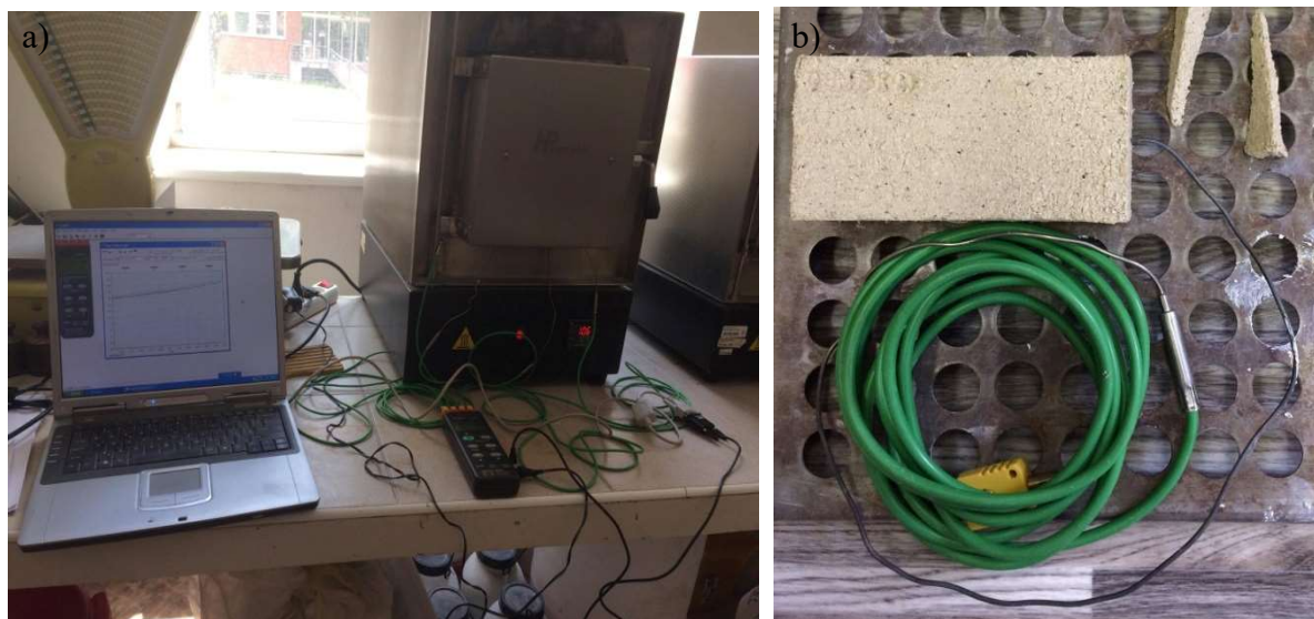
Obrázek 25 – Měření teplot ve vzorku během výpalu. Obrázek a) Měření teplot ve vzorcích a současně vykreslování křivky v PC programu, obrázek b) Umístění měřícího termočlánku do vzorku
