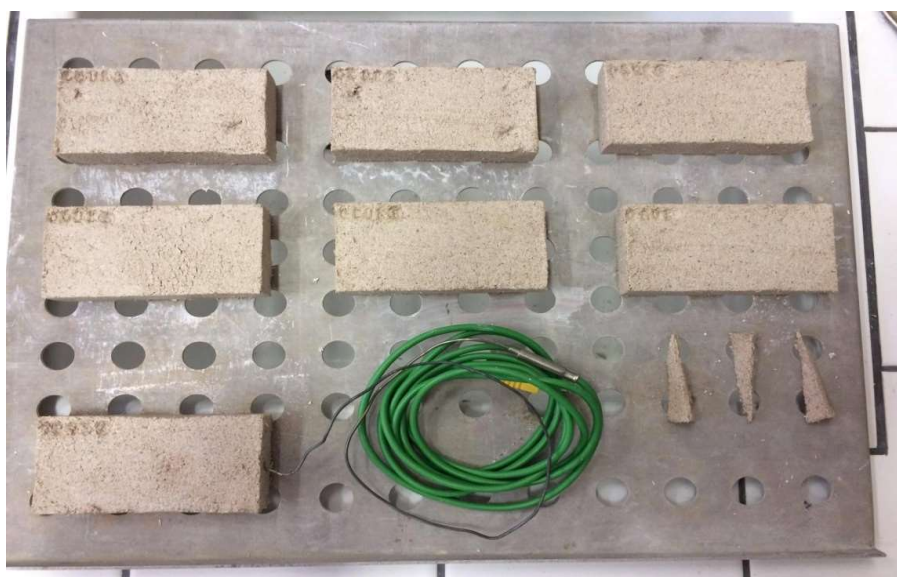
Obrázek 40 - Ukázka vytváření vzorků (na fotce vzorky lehčené bukovými pilinami)
