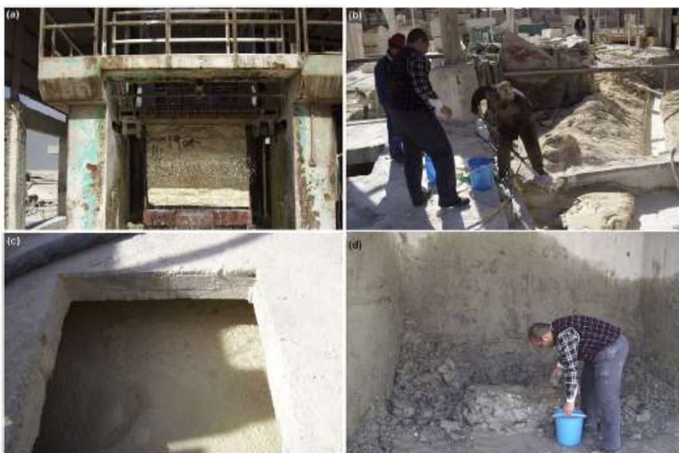
Obrázek 11 - Na fotkách lze vidět, jak vzniká odpad z okrasných kamenů. (a) Řezání bloků pomocí pil a vody, (b) Voda se smíchá s částicemi vytvořených při procesu řezání a pohybuje se v malých kanálech, (c) Produkt uložený v nádržích, (d) Z produktu je lisováním odstraněna voda [24]
