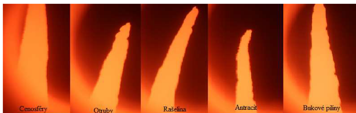
Obrázek 39 - Žároměrky při teplotě 1680 °C (pod každou žároměrkou je uvedeno jaké lehčivo vzorek obsahuje)
