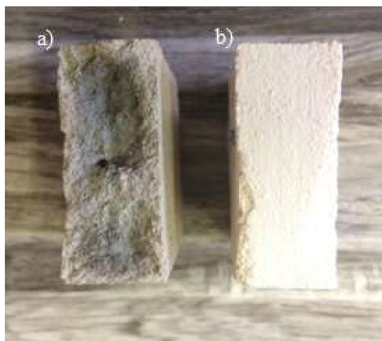
Obrázek 41 - Výskyt černého jádra při teplotě výpalu a) 500 °C b) 1000 °C
