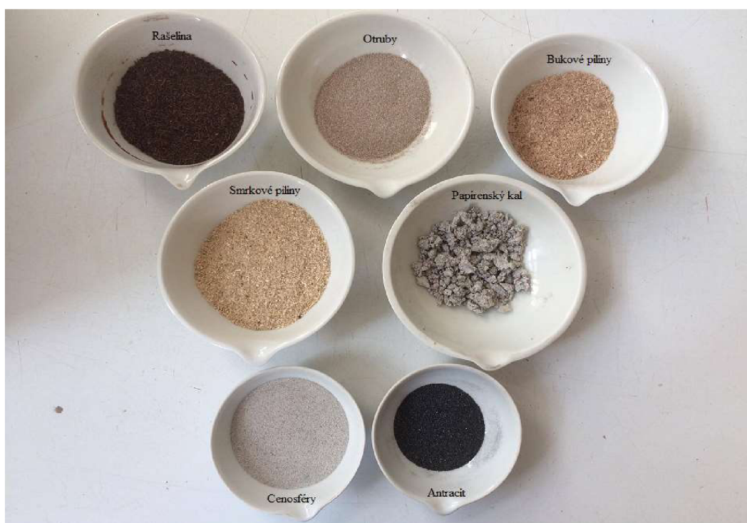
Obrázek 23 - Suroviny sloužící jako lehčiva pro výrobu lehčeného šamotu
