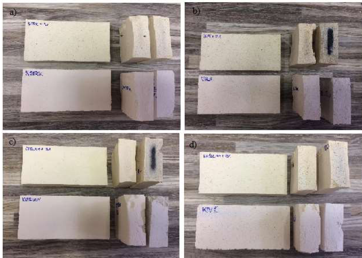
Obrázek 49 - Černá jádra vzorků. Na každém obrázku jsou zobrazeny vzorky s jílem B1 (barva béžová) a vzorky s kaolínem (barva narůžovělá), kdy u každého je zobrazen řez vzorku (levá strana je vzorek z pomalého výpalu, pravá strana je vzorek z rychlého výpalu). Lehčivem je a) smrk, b) buk, c) otruby, d) rašelina
