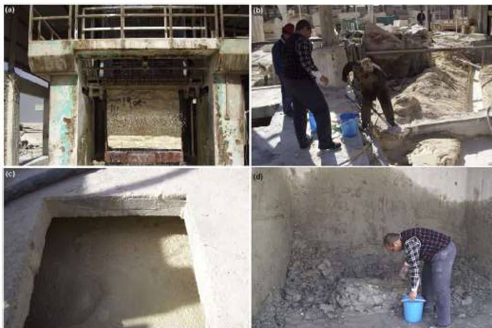
Obrázek 11 - Na fotkách lze vidět, jak vzniká odpad z okrasných kamenů. (a) Řezání bloků pomocí pil a vody, (b) Voda se smíchá s částicemi vytvořených při procesu řezání a pohybuje se v malých kanálech, (c) Produkt uložen v nádržích, (d) Z produktu je lisováním odstraněna voda [24]
