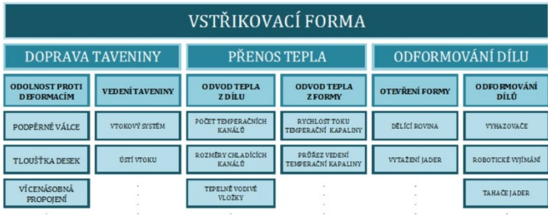
Schéma 2.7 Základní funkce a vlastnosti vstřikovací formy
