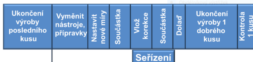
Schéma 2.10 Seřízení formy pomocí metody SMED
