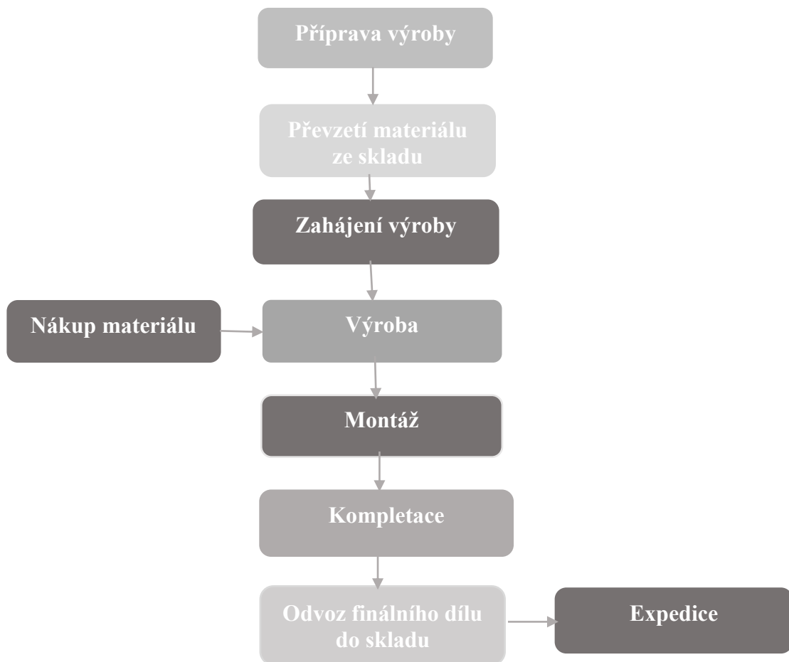
Schéma 2.3 Schéma výrobního procesu
