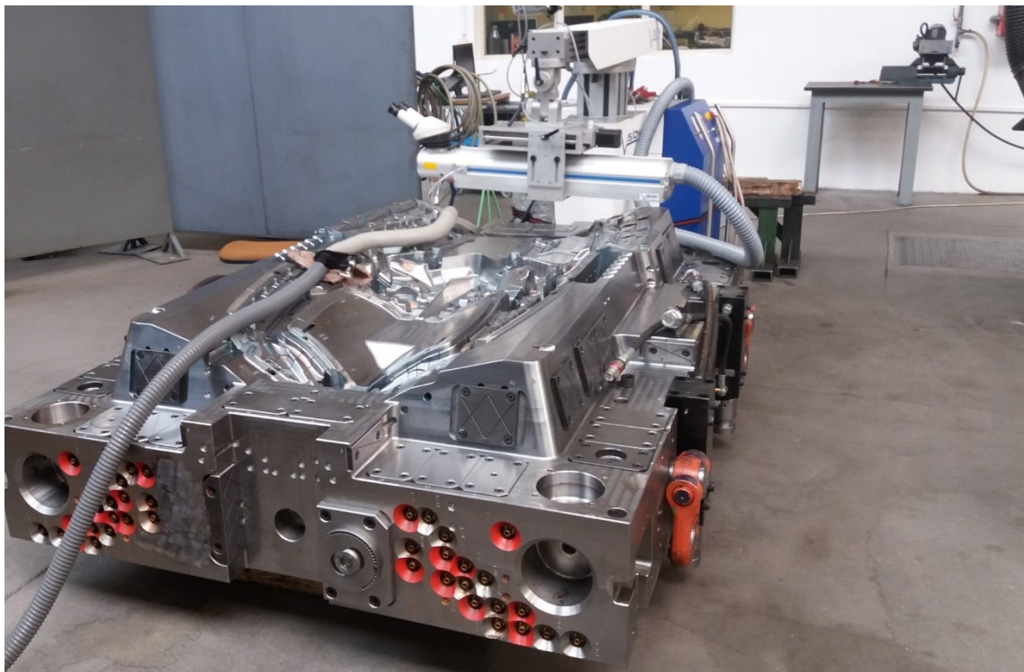
Obr. 4.2 Oprava formy navařováním pomocí laseru
