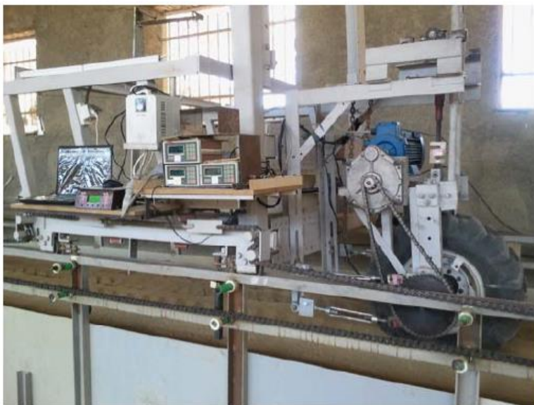
Obr. 8 Testovací hydraulický stojan s měřicí technologií (TAGHAVIFAR, MARDANI, 2013)
