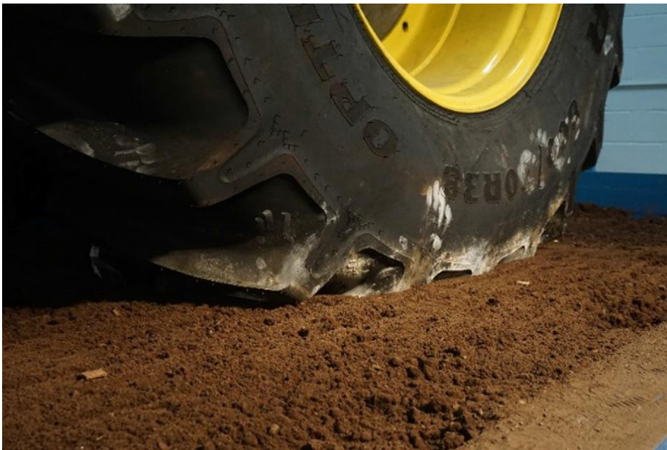
Obr. 10 Zatížená pneumatika v testovacím boxu laboratoře (KENARSARI, et. al., 2017)
