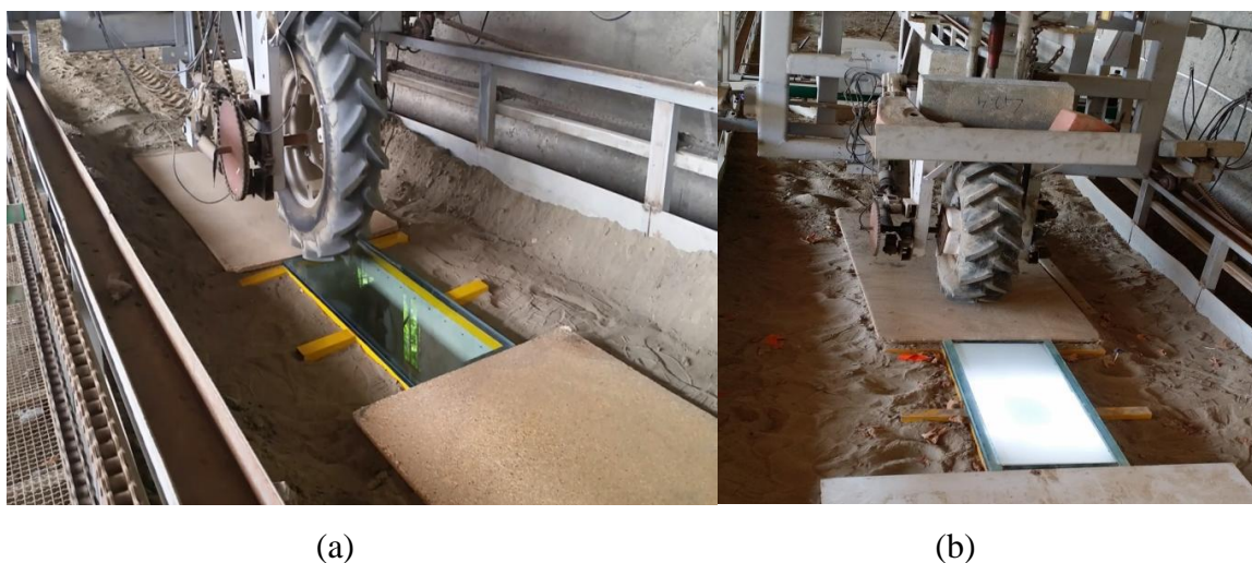
Obr. 13 Skleněná deska před (a) a po (b) polítkou barvou (DERAFSHPOUR, et. al., 2019)
