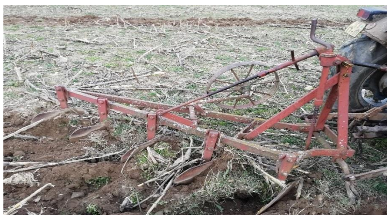
Snímek č. 3: Reálné provedení podmítky pluhem PN 532
