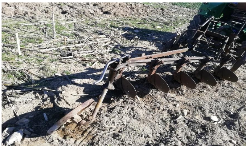
Snímek č. 1: Reálné provedení podmítky pluhem PZ U-51
