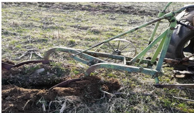
Snímek č. 4: Reálné provedení orby pluhem PN 252
