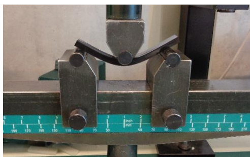
Obr. 3.17: Průběh zkoušky ohybových vlastností dle ČSN EN ISO 178 na zkušebním zařízení HOUNSFIELD H10KT
