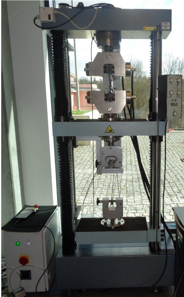
Obr. 3.15: Trhací stroj TIRAtest 2300, vpravo trhací stroj TIRAtest 2300 s použitím průtahoměru Epsilon 3542-010M-025-ST
