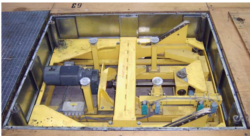
Obr. 4 Mechanická pohonná jednotka [vlastní zdroj].
