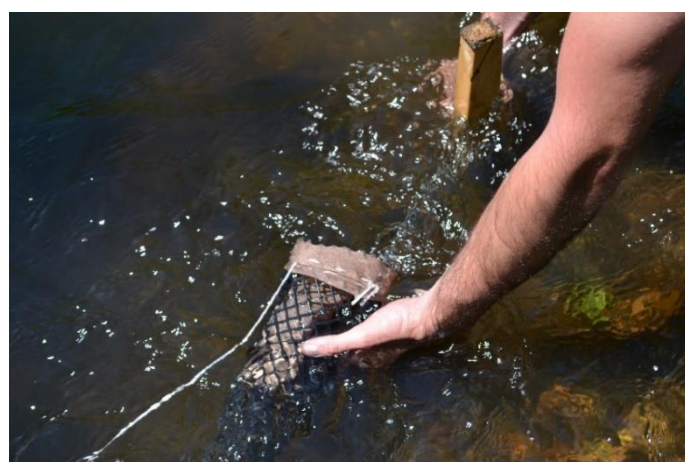
Obrázek 58 Instalace pasivního vzorkovače plavenin ve vybrané lokalitě řeky Březné (pořízeno 4.6.2014)
