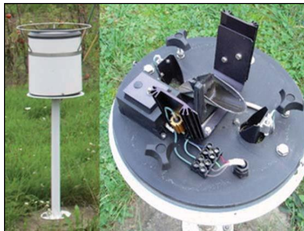
Obr. 19 Automatický člunkový srážkoměr MR3H (Kněžíková a kol., 2010)
