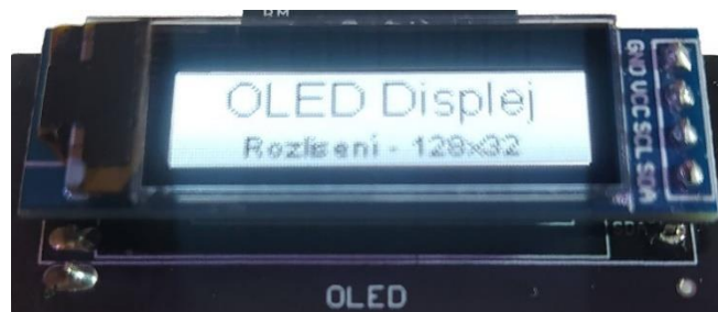
Obrázek 3.5: OLED Displej přímo na plošném spoji
