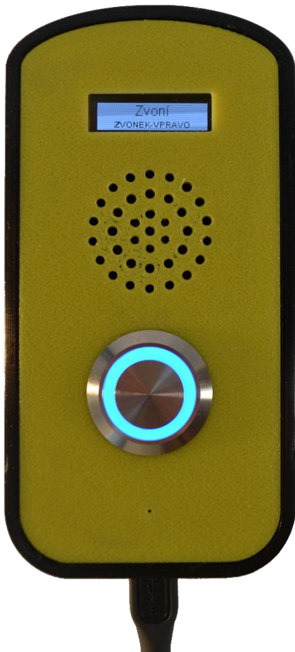
Obrázek 5.3: Přijímací jednotka indikující zvonění
