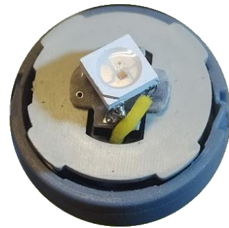
Obrázek 3.4: Vnitřek tlačítka doplněný o digitální LED
